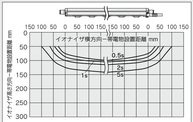
2) 高速除電カートリッジ、供給圧力:0.3MPa
